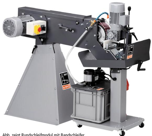
Abb. zeigt Rundschleifmodul mit Bandschleifer
